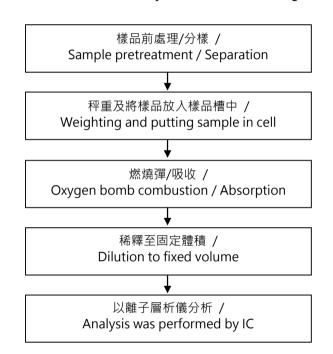
鹵素分析流程圖 / Analytical flow chart - Halogen
