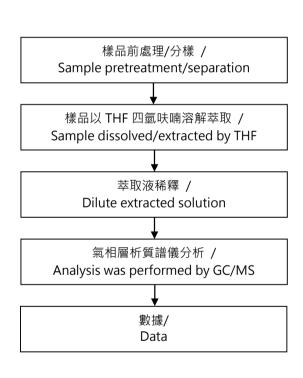
【測試方法/Test method: IEC 62321-8】
